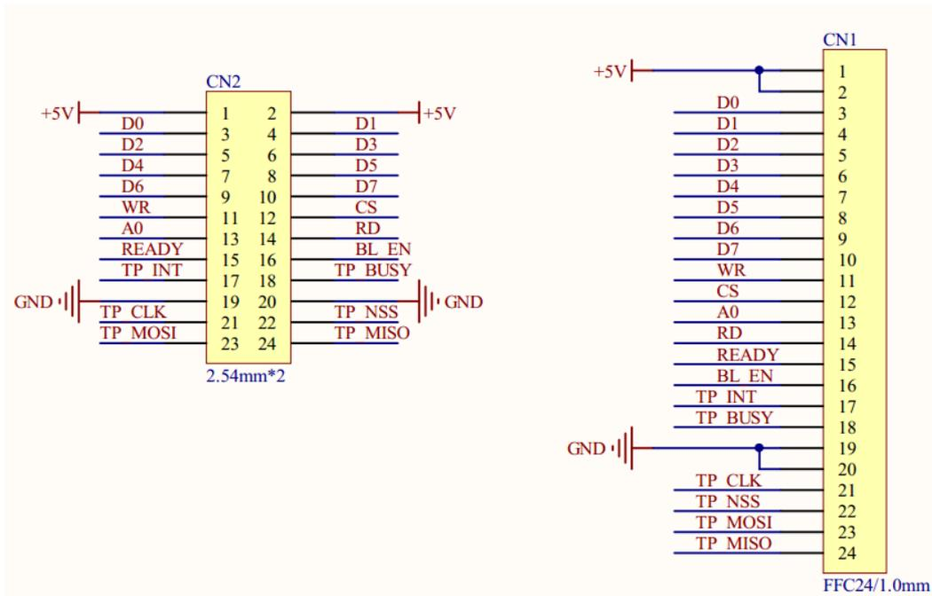
**CN2 ( 2.54mm 双排针 ) / CN1 ( 1.0mm FFC 连接器 )**
