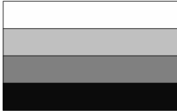
图 6-48 : 4 灰阶图案显示的例子
